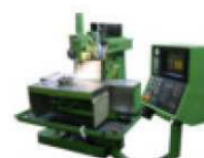
CNC-Fräsmaschine mit Universalfräskopf Teilapparat als 4. Achse Verfahrwege: X = 700 mm Y = 500 mm Z = 500 mm
